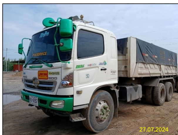
รูปที่ 2-3 การใช้ผ้าใบปิดคลุมรถบรรทุกและผูกมัดวัสดุอุปกรณ์รถบรรทุกขณะขนย้าย
